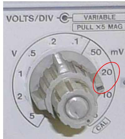
Selettore (**VOLTS/DIV**) da utilizzare per variare la visualizzazione (verticale) dell'onda sullo schermo
